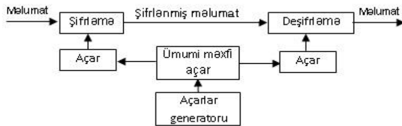
Şəkil 1. Simmetrik kriptosistemlərdə məlumatı göndərən və qəbul edən məxfi açarın qoşulması
